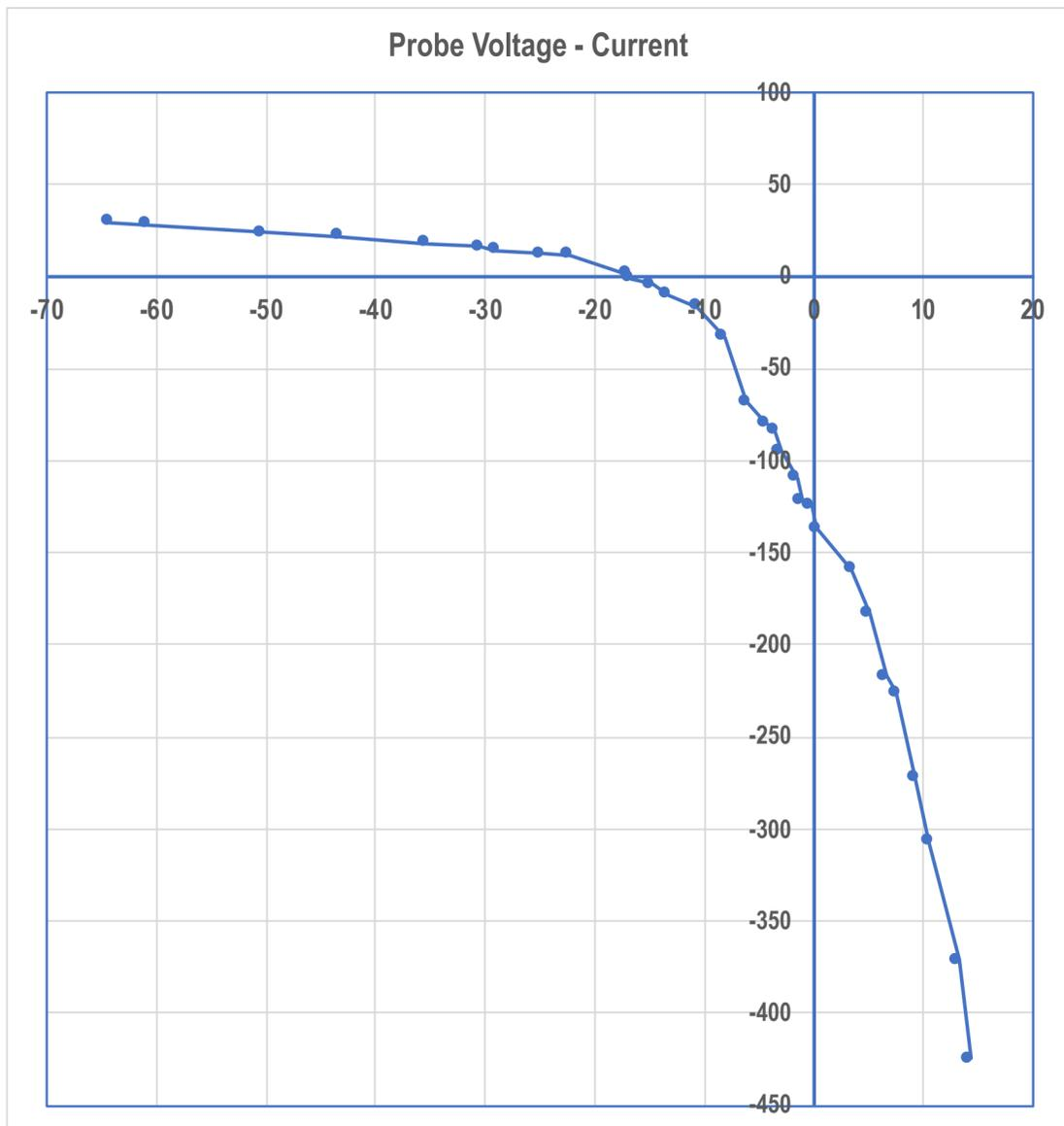
Plasma Probe Current (subtracting 10 MΩ)
